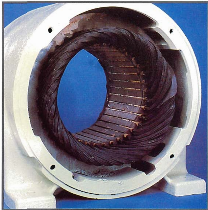
10 過載造成線圈損毀
