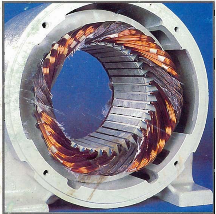
2 線圈單相運轉 ( \Delta 結線法)
