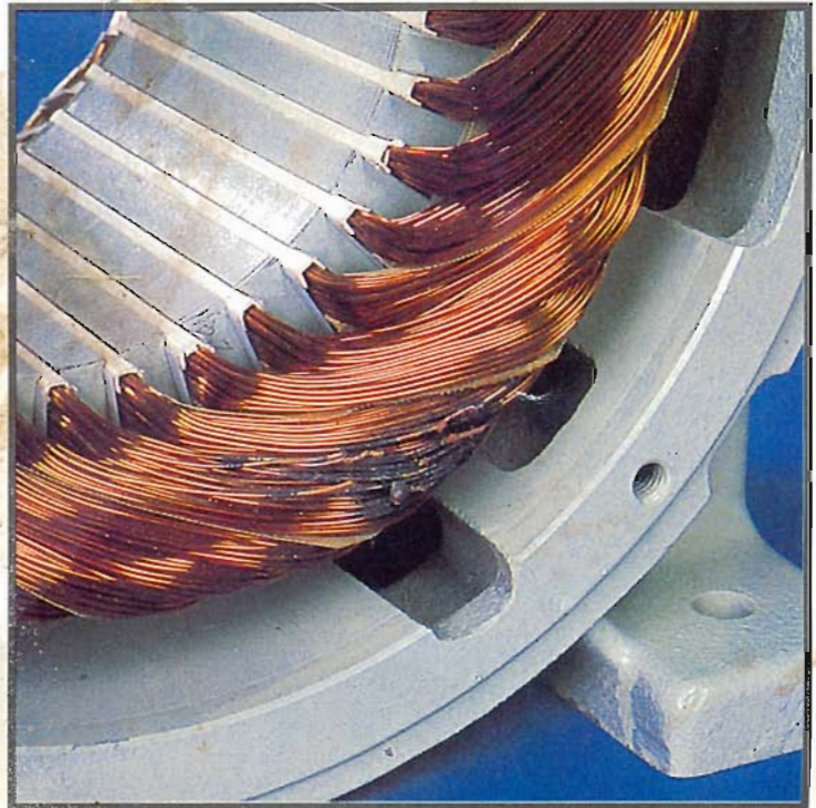
4 線圈圈間短路
